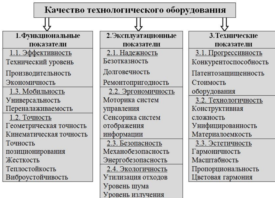
Рис. 2. Классификация показателей качества технологического оборудования
